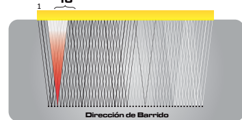
Barridos a alta velocidad sin partes móviles. Comparado con un transductor de un solo elemento, la tecnología de arreglo de fases ofrece una mucho mayor sensibilidad al uso de un pequeño haz focalizado.
