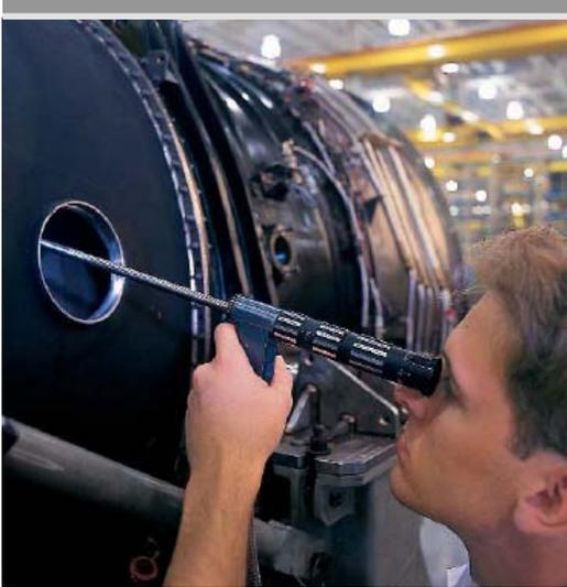
Inspección en Motores de Aeronaves
