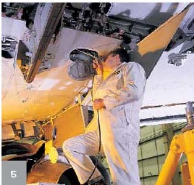
Inspección en áreas difíciles de estructuras de aeronaves
