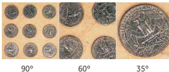
El área de visualización más completo pero con la menor amplificación. El campo de visualización de 90° muestra una imagen completa pero con la menor amplificación. El campo de visualización de 60° y 35° proporcionan aumento en la más grande amplificación.
