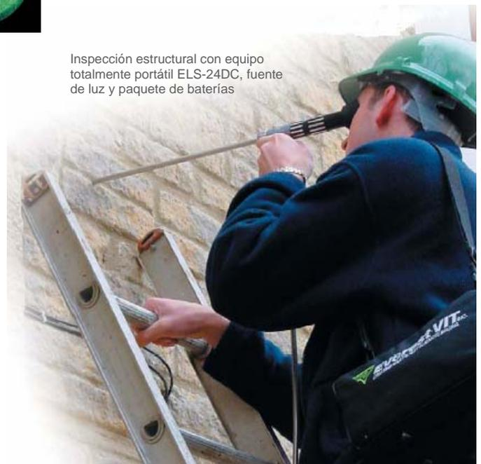
Inspección estructural con equipo totalmente portátil ELS-24DC, fuente de luz y paquete de baterías
