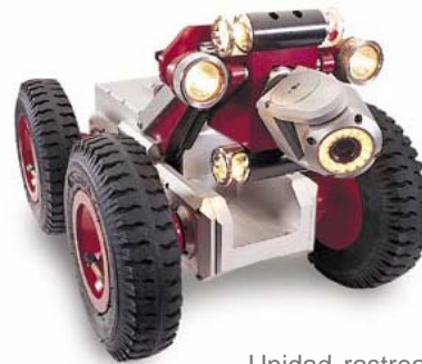
Unidad rastreadora con cámara e iluminación superior auxiliar
