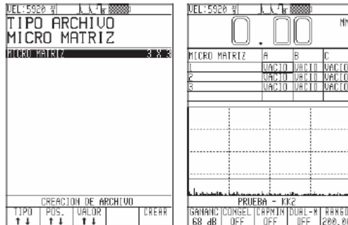
La Microgrid se guarda junto con el valor de medición que le sirve de base. Primero tiene que guardar siempre un valor de medición para poder crear una Microgrid sobre el mismo.
