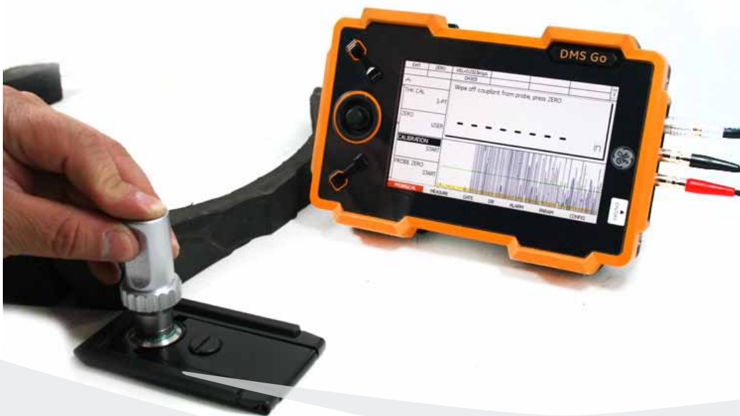
Modificar la ganancia a modo manual y cambiar el valor entre 85dB a 87dB
