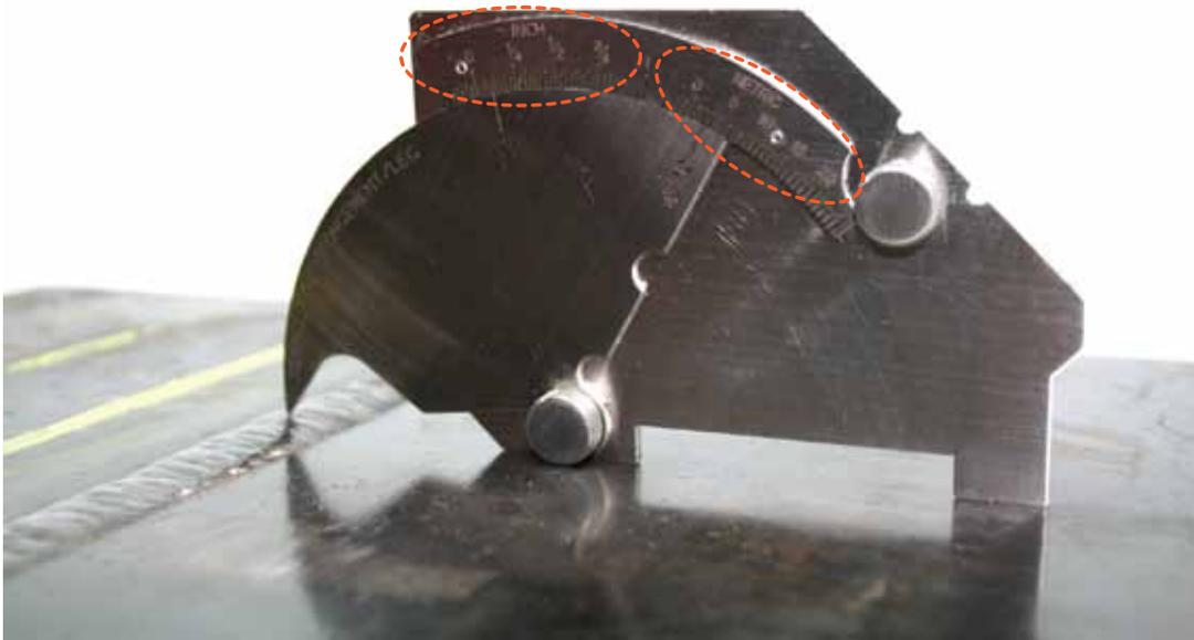
Fig. 2 Medición del Exceso de Soldadura
