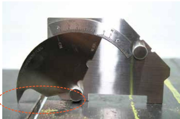
Fig. 7 Medición de alineación en dos placas
