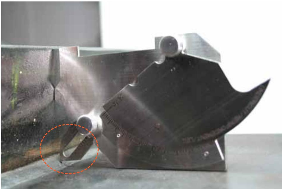
La cuarta aplicación es la de Tamaño de garganta de soldadura de filete, para ello debemos de colocar el **BRIDGE CAM** como se muestra en la siguiente figura:
