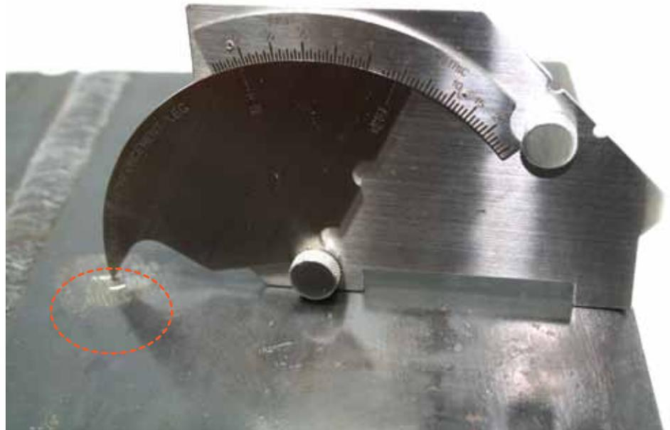
Fig. 3 Medición de Socavados
