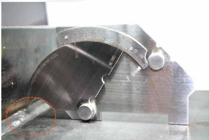
Fig. 5 Medición de longitud de soldadura de filete
