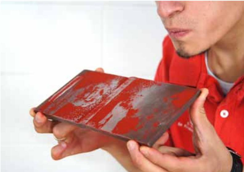
3. Como siguiente paso eliminamos el exceso de partículas magnéticas de la superficie, esto se hace únicamente soplando uniformemente la pieza.
