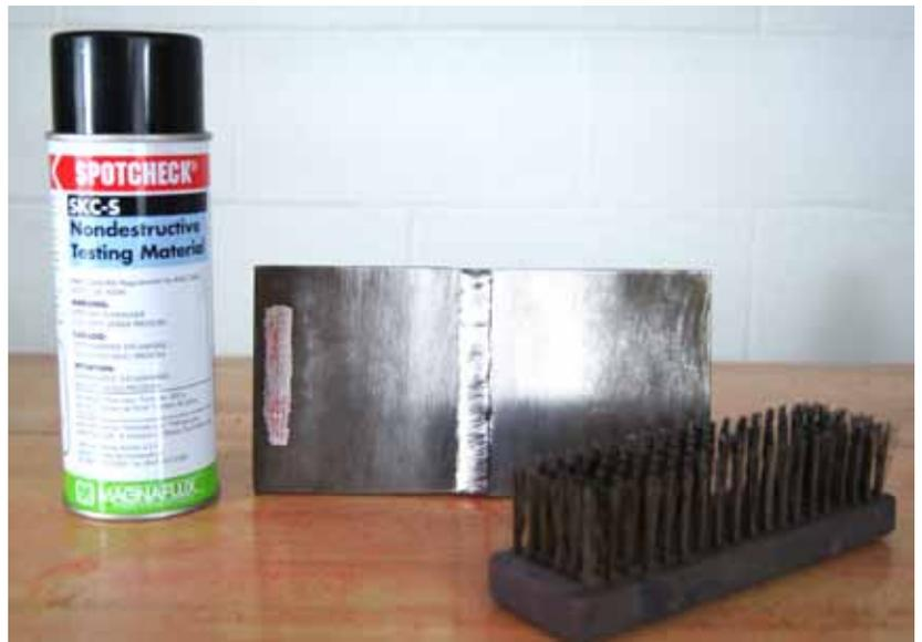
2. Inducir magnetismo, colocando el yugo magnético sobre la pieza y a su vez aplicar las partículas magnéticas rosas, una vez que las partículas ya estén aplicadas totalmente sobre la pieza, retiramos el yugo.
