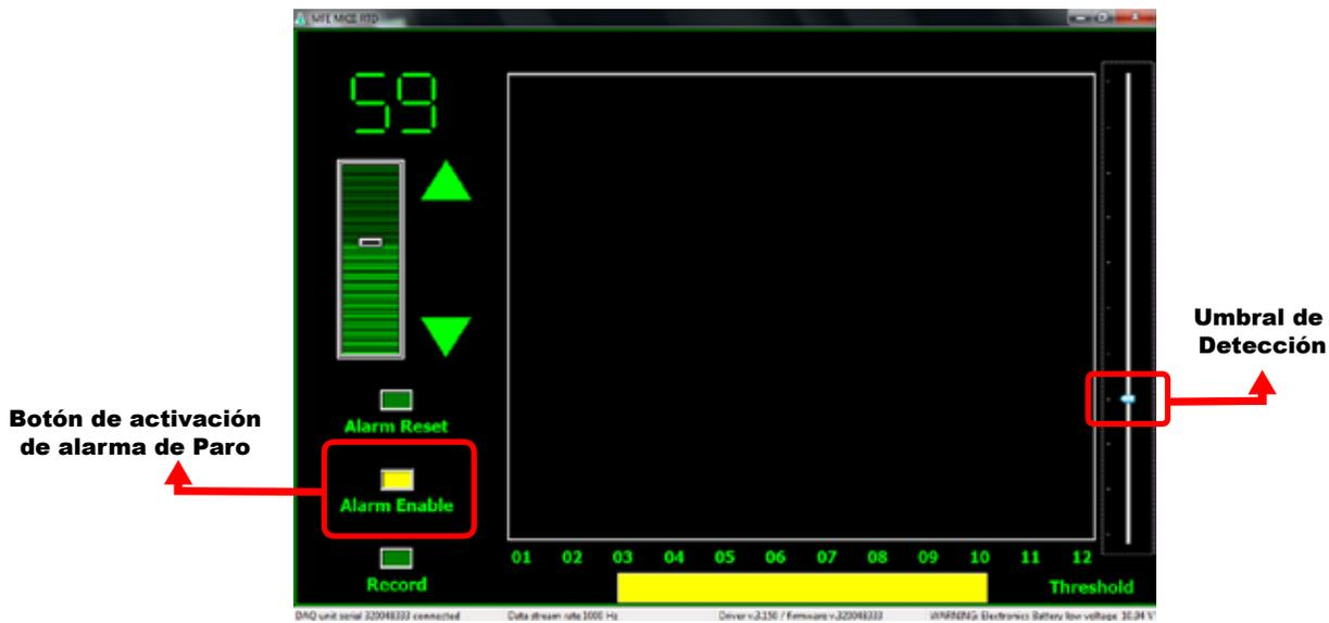
Al realizar el barrido sobre la placa y el equipo encuentre una discontinuidad que este por arriba del umbral, el equipo se detendrá mostrando en la pantalla con que sensores se está localizando la misma.
