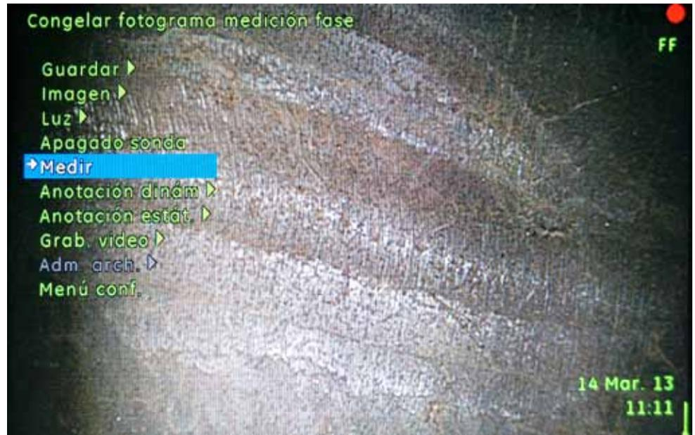
Para generar la vista 3D debemos realizar primero la medición en perfil de profundidad, colocaremos dos cursores sobre la imagen; con la ayuda de la opción **MTD (Distancia Máxima del Objeto, distancia entre el lente y la pieza de prueba)** en la parte inferior, sabremos si los cursores se encuentran a la misma profundidad.
