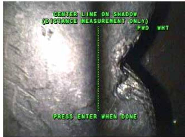
En la mayoría de las aplicaciones primero se realiza una inspección en la que se utiliza un lente de visión para localizar las discontinuidades; después se requiere extraer la sonda para cambiar el lente por uno de medición, sin embargo, en este proceso se corre el riesgo de no localizar la misma discontinuidad, la misma orientación o tomar más tiempo para localizarla y realizar la medición.
