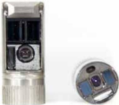
Ahora con la tecnología de **Medición en 3D** contamos con una ventaja, ya que ahora con un lente ya sea de visión lateral o de visión frontal nosotros podremos realizar la medición **“sin necesidad de extraer la sonda para cambiar el lente”**.
