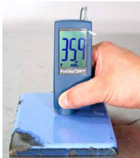
Placas con espesor de recubrimiento de entre 30 a 40 milésimas.
