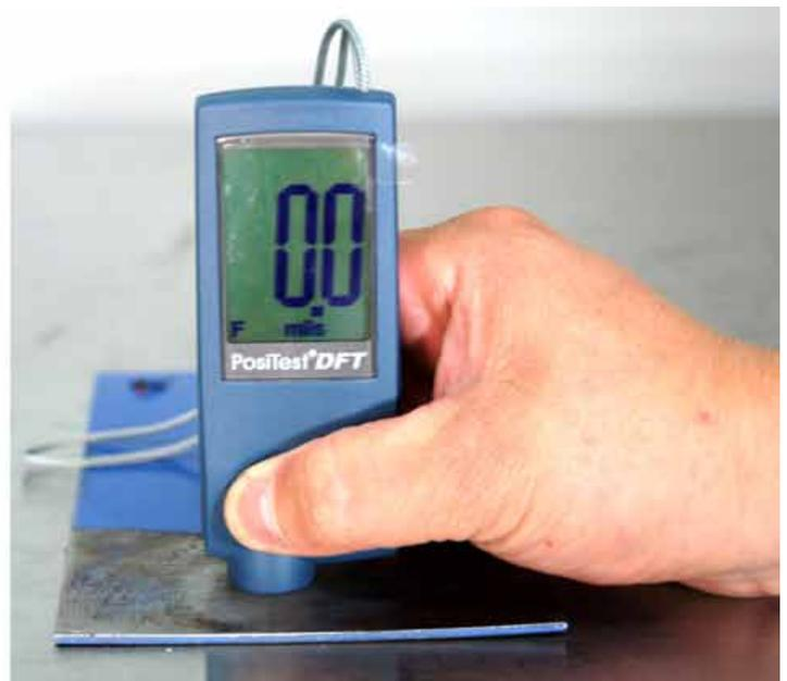
3. Ahora realizaremos las mediciones sobre las placas con el recubrimiento, obteniendo los siguientes valores.
