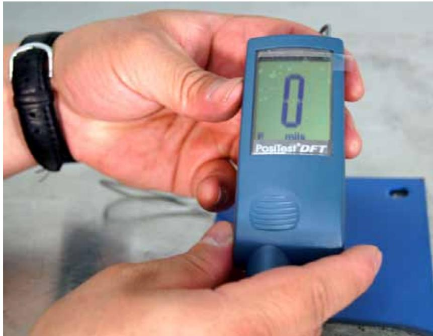
2. Colocar el equipo sobre el material sin recubrimiento y de forma automática realizará el ajuste a cero.
