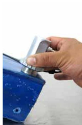
El utilizar un equipo con pulso cuadrado y un transductor de baja frecuencia permite obtener una buena relación Señal-Ruido, es decir una buena amplitud de señales con un mínimo de ruido en la línea de tiempo base.
