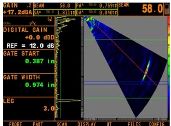
Una vez localizadas, configuramos el equipo con la función "TOP VIEW" colocando el Encoder en una posición antes de las discontinuidades, lo desplazaremos nuevamente sobre la pieza de prueba obteniendo las siguientes indicaciones.
