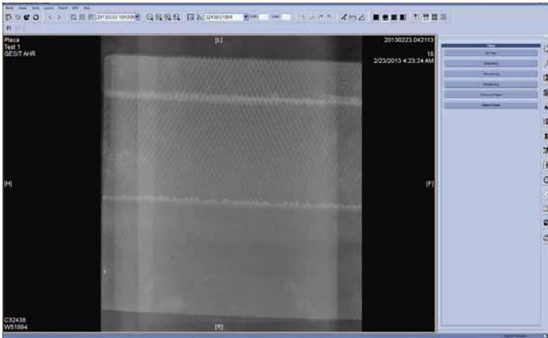
En la imagen izquierda tenemos la imagen digitalizada sin **Flash Filter** y a la derecha la imagen con **Flash Filter** en la que se pueden apreciar mejor la desalineación de las fibras y una ruptura de las mismas.
