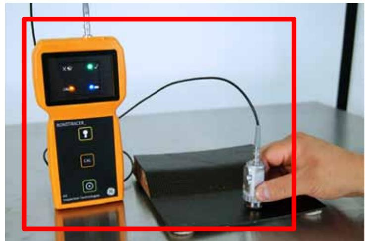
Al realizar la inspección sobre el componente el equipo nos mostrará un **LED** de color Verde para las partes en las que cuenta con los mismos atributos y un **LED** de color Rojo cuando los atributos del material cambien por cualquier circunstancia, ya sea una des - laminación, falta de adherencia o ruptura de las fibras, como se muestra a continuación.
