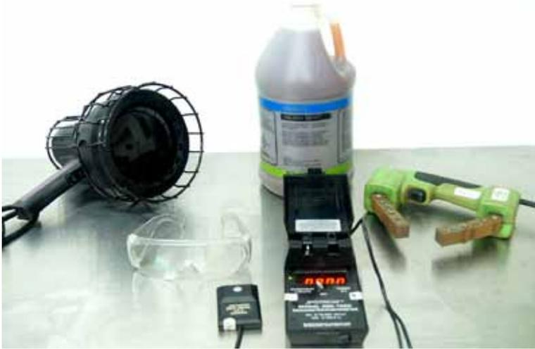
En la industria la detección de discontinuidades superficiales se puede llevar a cabo por diferentes métodos, entre ellos Líquidos Penetrantes o Partículas Magnéticas, en esta aplicación utilizaremos Partículas Magnéticas Fluorescentes de acuerdo al documento **ASTM E 709**, el cual tiene requerimientos que se deben cumplir en la inspección, principalmente la verificación de la intensidad de luz ya que de ella depende que esta sea la adecuada para obtener buenos resultados.
