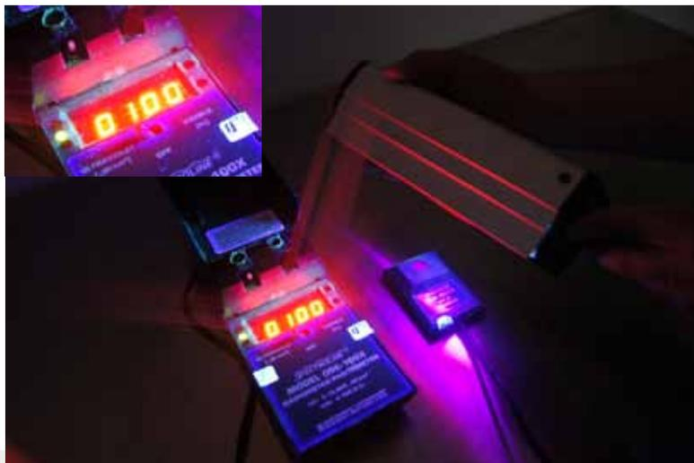
Una vez que se ha verificado y comprobado que se cumple con lo especificado con el documento, realizaremos la prueba en la pieza a inspeccionar, observando cómo se forman las indicaciones al magnetizar y aplicar las **Partículas Magnéticas Fluorescentes**.
