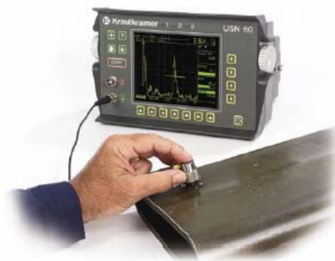
Pulsador de onda cuadrada con pulso de amplitud que solventa las aplicaciones de pruebas complejas.
